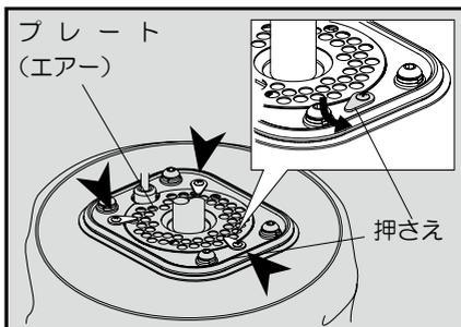
3. プレート（エア）を外して、フィルターを交換します。
