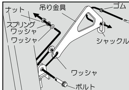
5. ボルトおよびナット（M12）をゆるめたまま、もう一方のシャックルにゴムを通して発電機吊り上げフックにつないでください。
