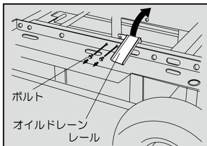
4. 発電機後部（排気口の反対側）を持上げて後輪を載せます。
