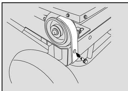
9. オイルドレーンレールを取り付け、ボルト (M6) で締付けます。
