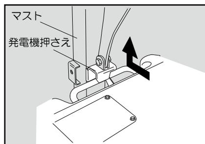
3. 発電機車輪押えを2ヶ所（ボルト4ヶ所）取付けます。
