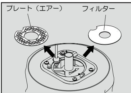
4. 交換したフィルターの上にプレート（エア）をはめ込み、押さえを戻して固定します。
