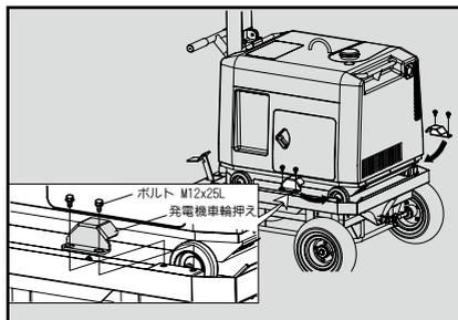
4. 吊り金具の一方をマストの発電機押さえにワッシャ、スプリングワッシャ、ボルトおよびナット（M12）を使用して取付けます。
