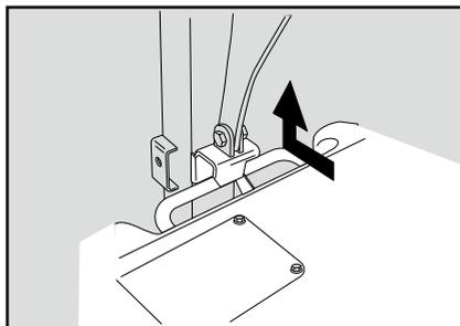
8. 車輪押さえを取り付け、ボルト (M12) で車輪が動かないように左右両側を締付けます。
