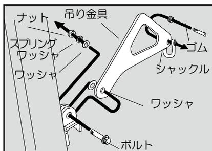
11. ボルトおよびナット（M12）をゆるめたまま、もう一方のシャックルにゴムを通して発電機吊り上げフックにつないでください。
