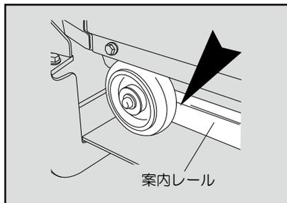
7. 後部の手すりパイプを発電機押さえにはめ込むようにして発電機を完全に載せます。
