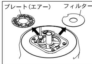
プレート(エアー)を外して、フィルターを取り外します。
