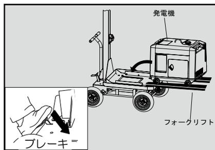
2. 後部の手すりパイプを発電機押さえにはめ込むようにして発電機を完全に載せます。
