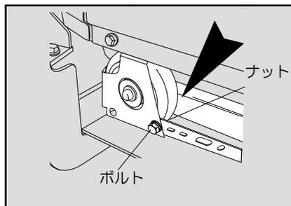
7. 吊り金具の一方をマストの取付位置にワッシャ、スプリングワッシャ、ボルトおよびナット (M12) を使用して取付けます。
