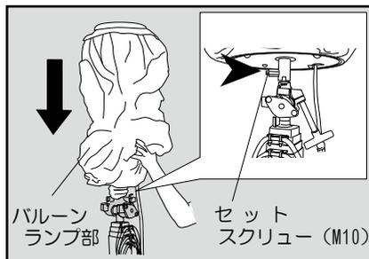
2. コンタクトを接続し、カバーネジを締め付けます。
