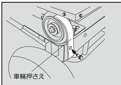
5. 後輪押さえを発電機後輪に側面からかぶせるように取付けます。レールの裏側からナットを使って、車輪押さえを締付け発電機車輪を固定します。
