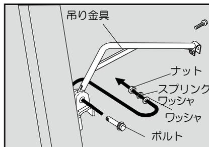
8. 吊り金具のもう一方を発電機のフレーム中央の被せ、吊り金具の締め付けボルト (M12) を締付けてください。
