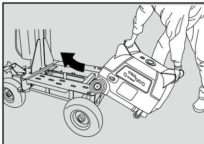
4. 車輪押さえ側から先ほど外したボルト (M12) を左右両前輪押さえを取り付けます。
