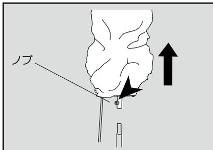
2. フィルター側が上にくるように外したバルーン部を置き、プレート（エア）の3箇所の押さえをスライドさせます。
