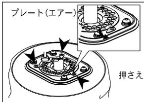
フィルター側が上にくるようにバルーン部を置き、プレート(エアー)の3つの押さえをスライドさせます。
