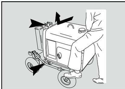
6. 発電機コントロールパネル下の車輪の内側に右図のように案内レールに接しているように押し入れてください。
